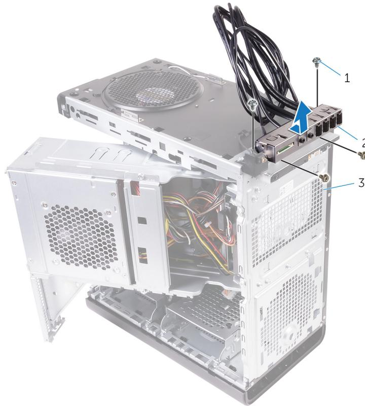
**Ilustración 28. Extracción del panel USB**
