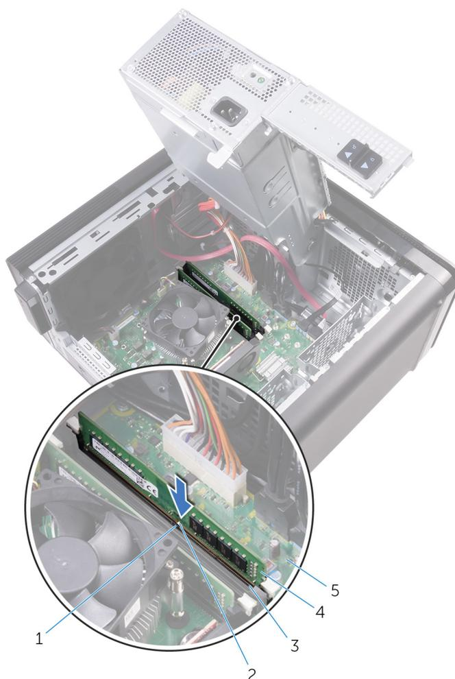
**Ilustración 25. Colocación del módulo de memoria**
