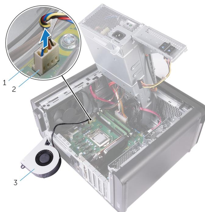
**Ilustración 31. Extracción del cable del extractor**
