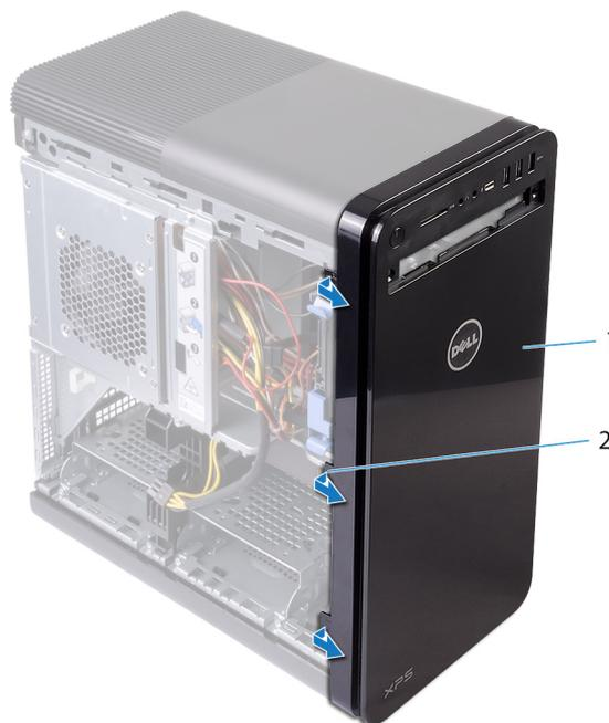
**Ilustración 3. Extracción del bisel frontal**
