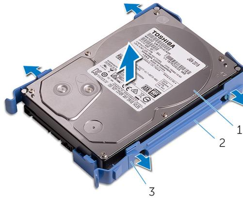
**Ilustración 14. Extracción de la unidad de disco duro del soporte**
