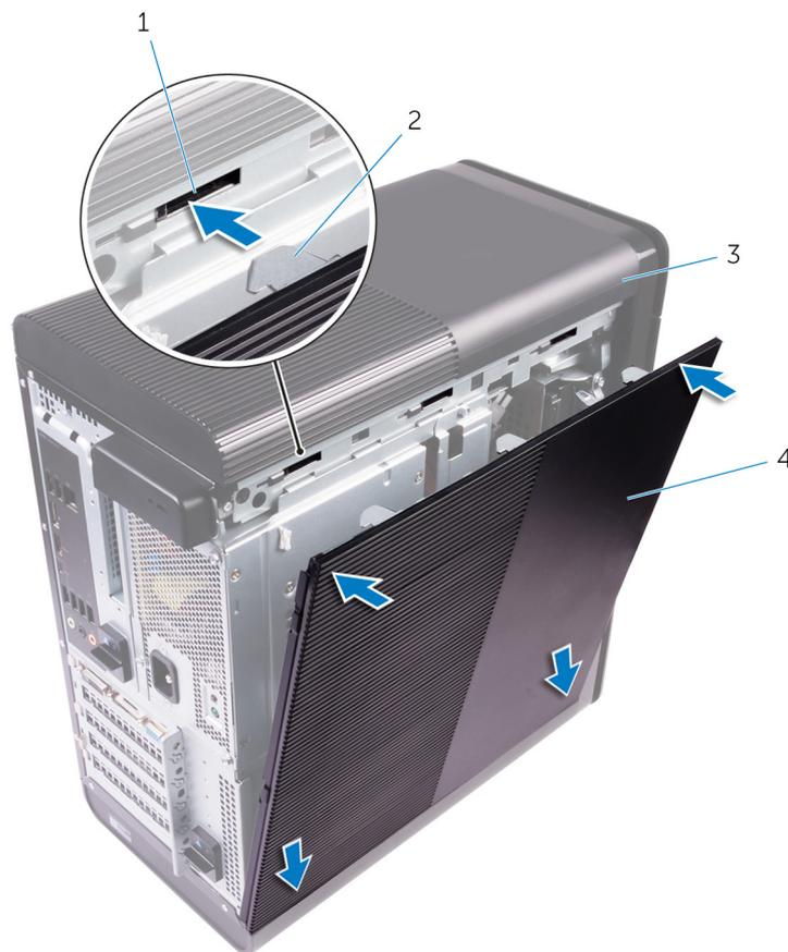
**Ilustración 2. Reemplazo de la cubierta lateral derecha**
